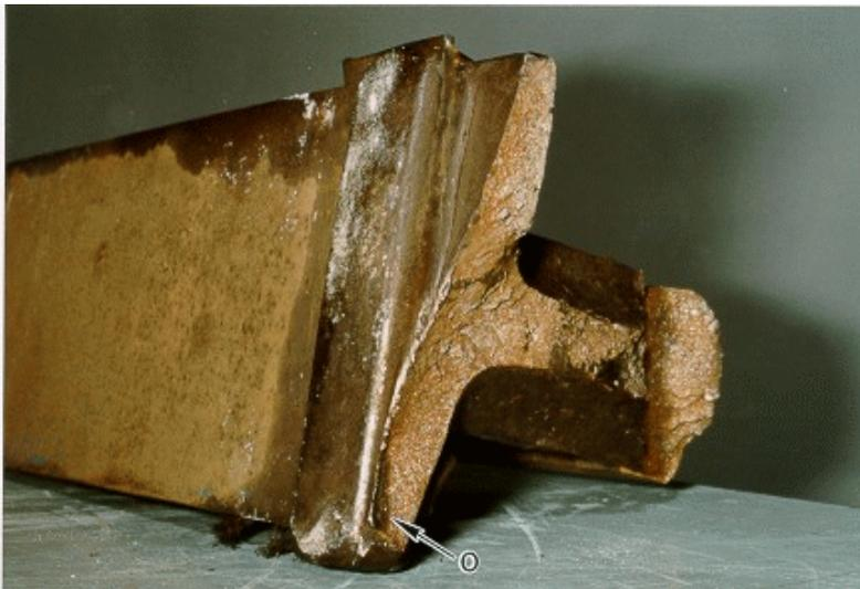
Les deux surfaces de contact de la préfiissure ont été découpées dans les sections de rail est et ouest. L'analyse de ces bouts de rail au microscope électronique à balayage et au microscope métallographique a confirmé que la préfiissure avait pris naissance dans une zone de ferrite aciculaire, en l'occurrence une microstructure ayant une faible résistance à la rupture et aux chocs, et qu'il n'y avait pas eu d'agrandissement récent de la préfiissure.
