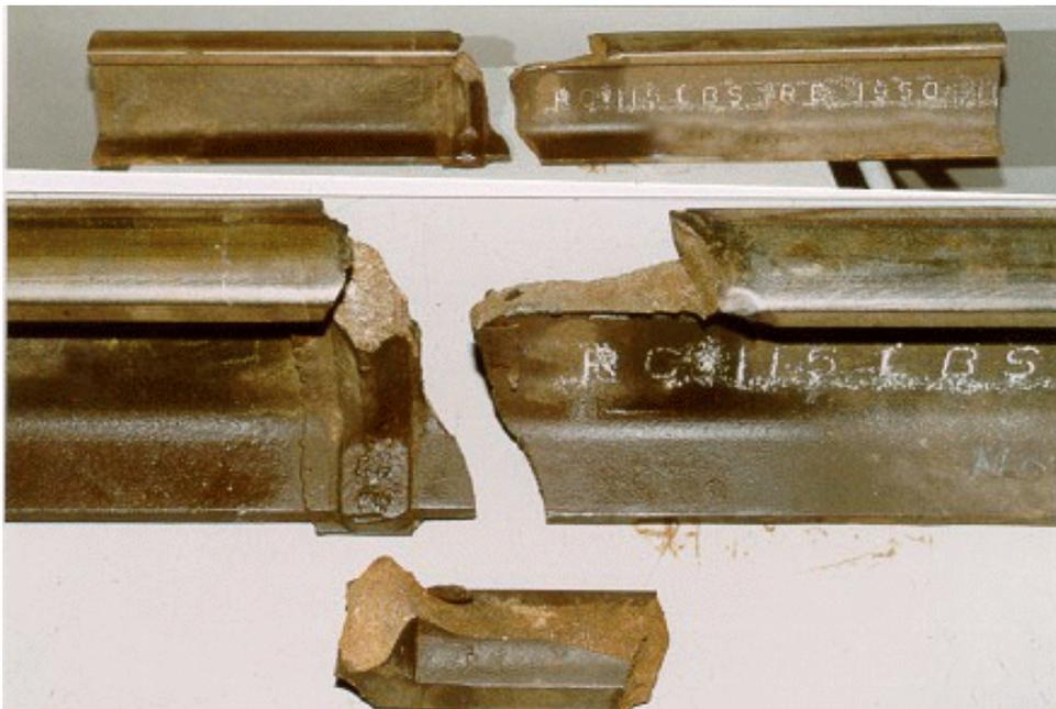
Le rail à l'est de la rupture a été laminé en 1950 et celui à l'ouest, en 1979. L'usure verticale et l'usure latérale des rails respectaient les limites admissibles de la CMN 3200 du CN pour les rails de 115 livres, à savoir 16 mm (5/8 de pouce) pour l'usure verticale et 21 mm (13/16 de pouce) pour l'usure verticale et l'usure latérale combinées.
