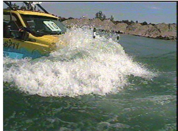
Dans l'eau perturbée, de forts embruns et une certaine quantité d'eau « solide » recouvraient le capot, entraînant un fort envahissement par les hauts par les ouvertures de ventilation, les manches à air et les côtés du capot. Cependant, la plus forte entrée d'eau était à l'avant, par-delà le joint à l'avant du capot et au-dessus de la visière avant, où le débordement entraînait un effet continu de chute d'eau. À 10,24 km/h, l'envahissement par les hauts et l'accumulation rapide
