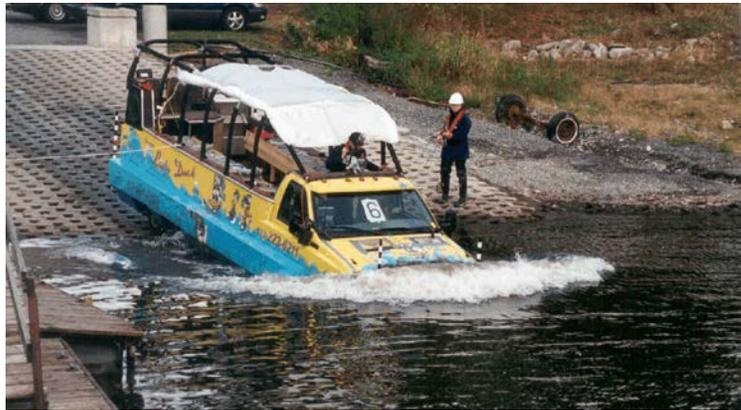
Lorsque le véhicule était en condition de charge maximale, les vitesses de mises à l'eau dépassant 8 km/h entraînaient une importante entrée d'eau. Dans l'exploitation, en l'absence d'alarme de niveau d'eau élevé dans la cale, la quantité réelle d'eau embarquée au début de chaque excursion ne peut pas être connue. Son refoulement dépendait de la mise en marche rapide de la pompe d'assèchement avant.
