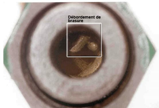
Au moment de leur installation au chantier naval, les tuyaux de raccordement des servocommandes étaient en cuivre. Les raccords de tuyauterie ont été effectués à l'aide des méthodes de brasage direct et de joints aboutés simples (figure 5). Les joints contenaient une grande quantité de brasure à l'extérieur, et le joint qui a été examiné minutieusement lors de l'enquête contenait un débordement de brasure dans le trou d'alésage interne (figure 6). On
