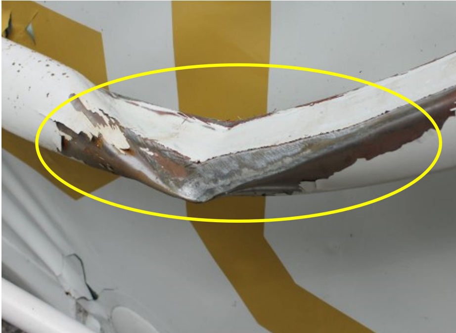
Figure 4. Photo des dommages causés au hauban de l'aile gauche par la collision avec le câble (Source : BST)
