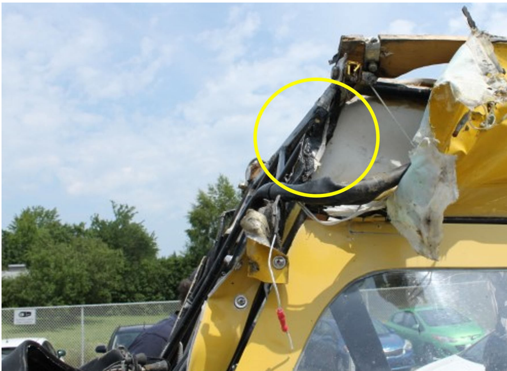
Figure 3. Photo des dommages causés au montant gauche du pare-brise par la collision avec le câble (Source : BST)
