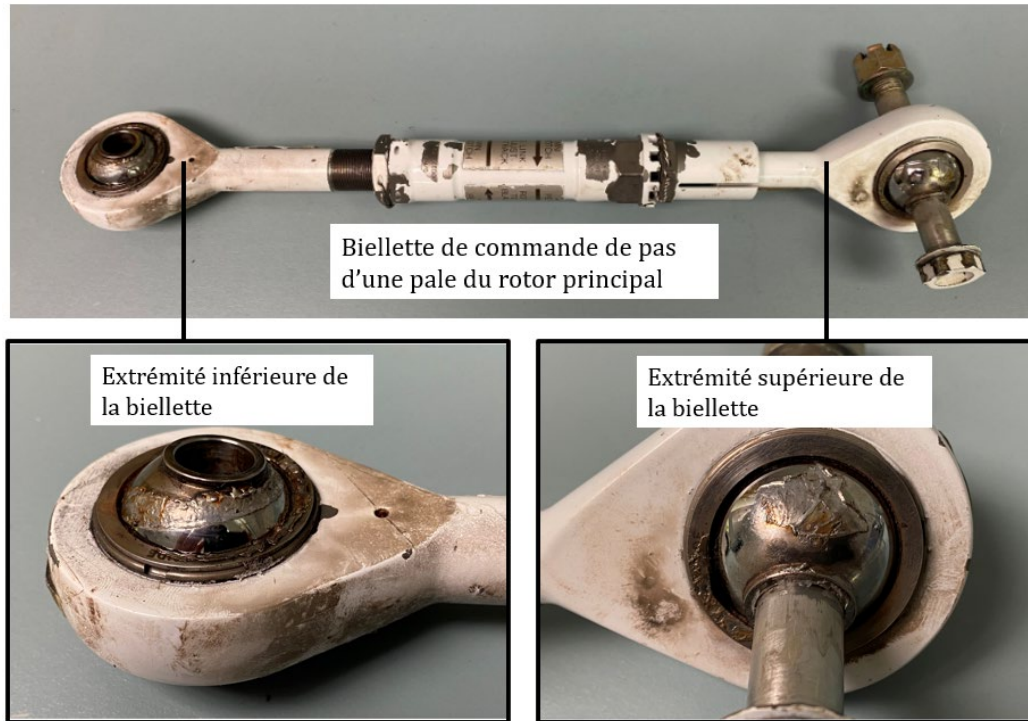
Figure 11. Bielle de commande de pas de la pale bleue du rotor principal de l'hélicoptère à l'étude, mettant en évidence les dommages subis par le palier à rotule (Source : BST)
