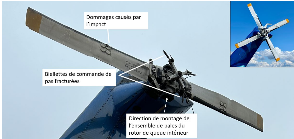
Figure 8. Image principale : Le système de rotor de queue de l'hélicoptère à l'étude après le foudroiement, montrant l'ensemble de pales du rotor de queue intérieur manquant et les dommages causés par son détachement. En médaillon : Le rotor de queue réparé de l'hélicoptère à l'étude, à titre de référence, en tant qu'ensemble complet. (Source de l'image principale : Helijet International Inc., avec annotations du BST. Source de l'image en médaillon : Helijet International Inc.)
