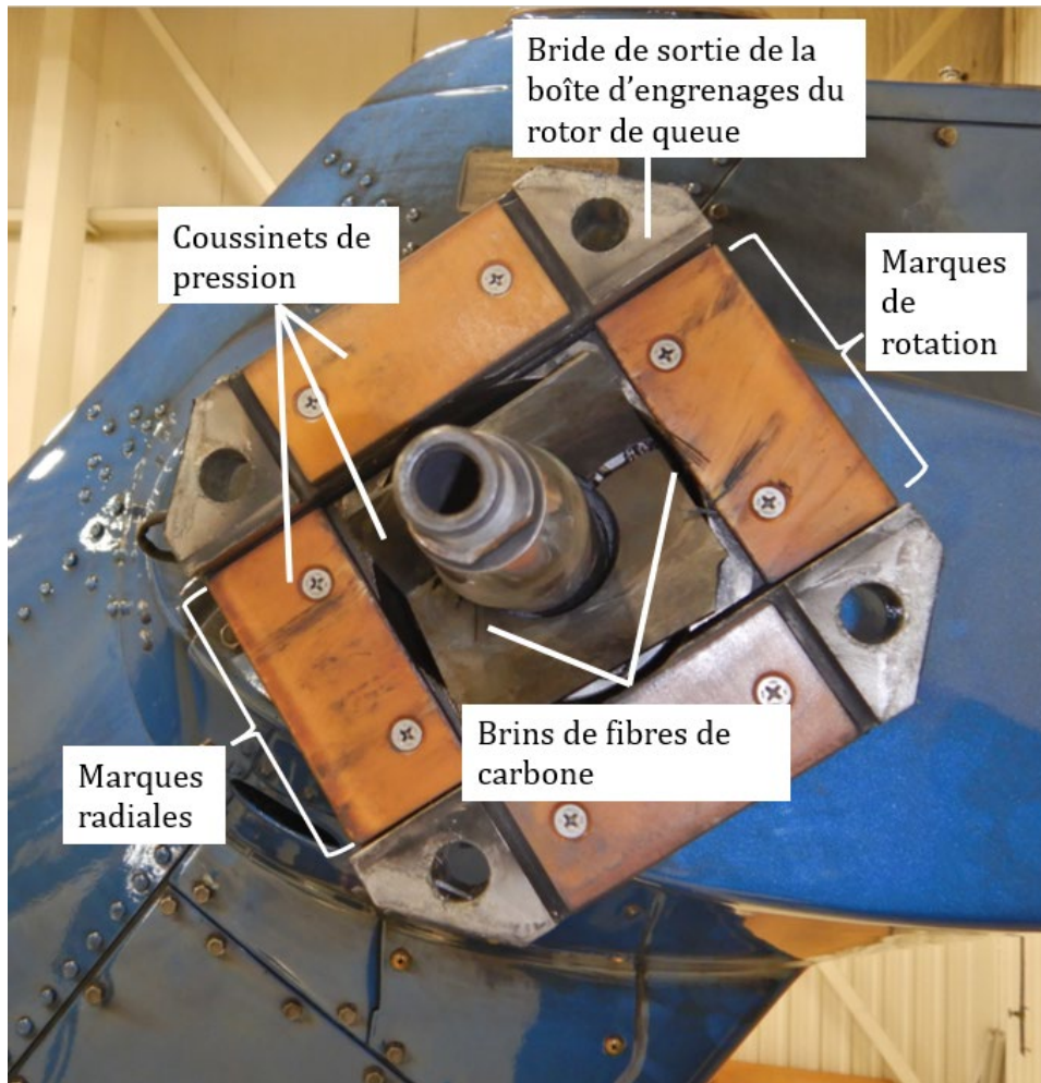
Figure 9. Bride de sortie de la boîte d'engrenages du rotor de queue de l'hélicoptère à l'étude, mettant en évidence les brins de fibres de carbone restants et les marques sur les coussinets de pression où était fixé l'ensemble de pales du rotor de queue intérieur (Source : BST)
