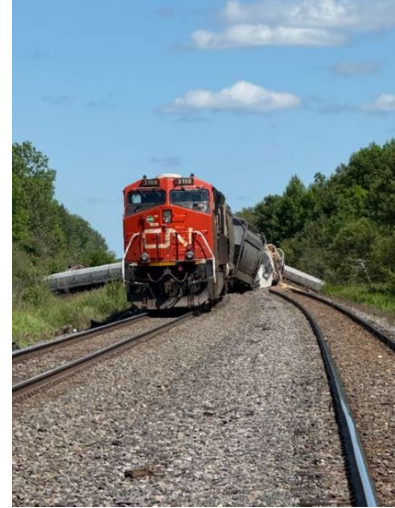
Figure 2. Vue de la locomotive en queue de train et des wagons déraillés (Source : Compagnie des chemins de fer nationaux du Canada)
