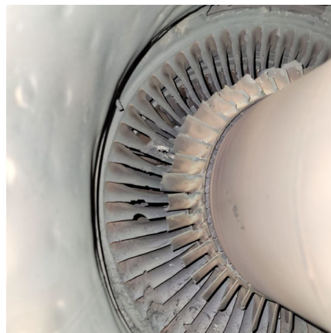
Figure 2. Vue du 2 e étage de la turbine de puissance de l'aéronef à l'étude présentant des aubes brisées, en regardant à l'intérieur par la gaine d'échappement (Source : BST)
