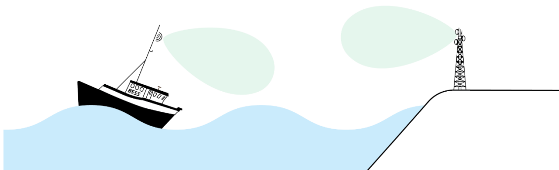
Figure 11. Diagramme montrant le désalignement des antennes du navire et à terre en mer agitée (Source : BST)
