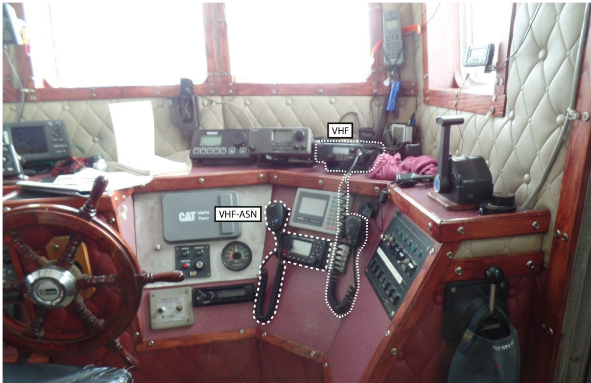
Figure 4. La console de navigation du Silver Condor, montrant la barre, le système de commande de propulsion, l'équipement de navigation et l'équipement radio du bateau (Source : tierce partie, avec autorisation et avec annotations du BST)
