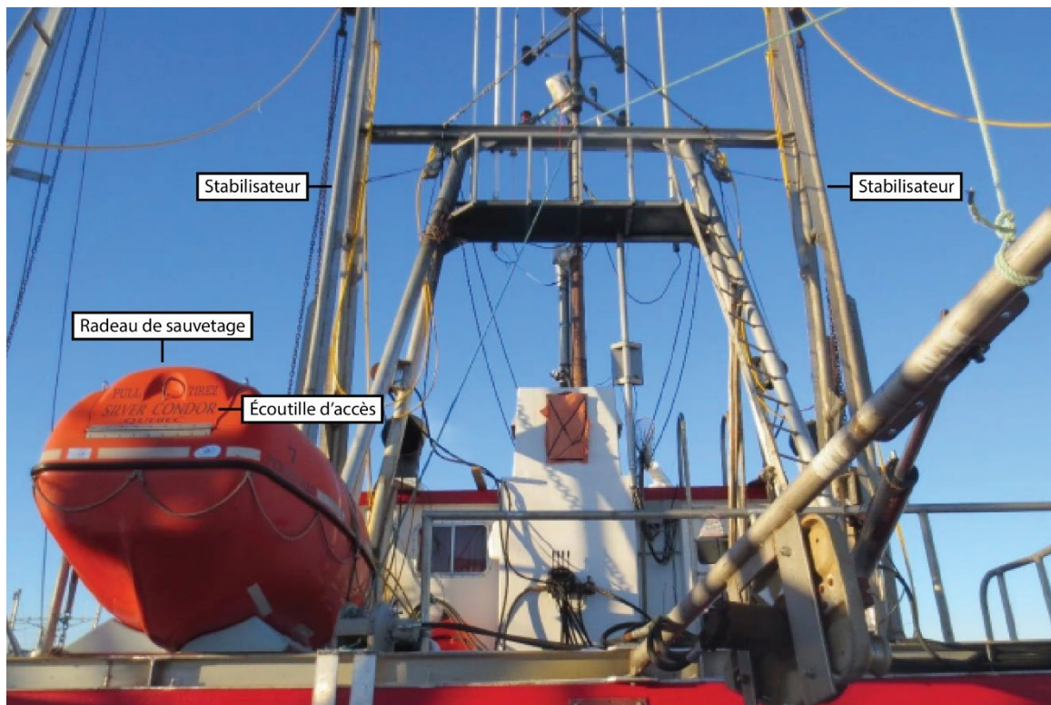
Figure 8. Vue du pont supérieur arrière du Silver Condor montrant le radeau de sauvetage du bateau avec ses engins de pêche (y compris des cordes, des câbles et des stabilisateurs) au-dessus (Source : tierce partie, avec autorisation et avec annotations du BST)
