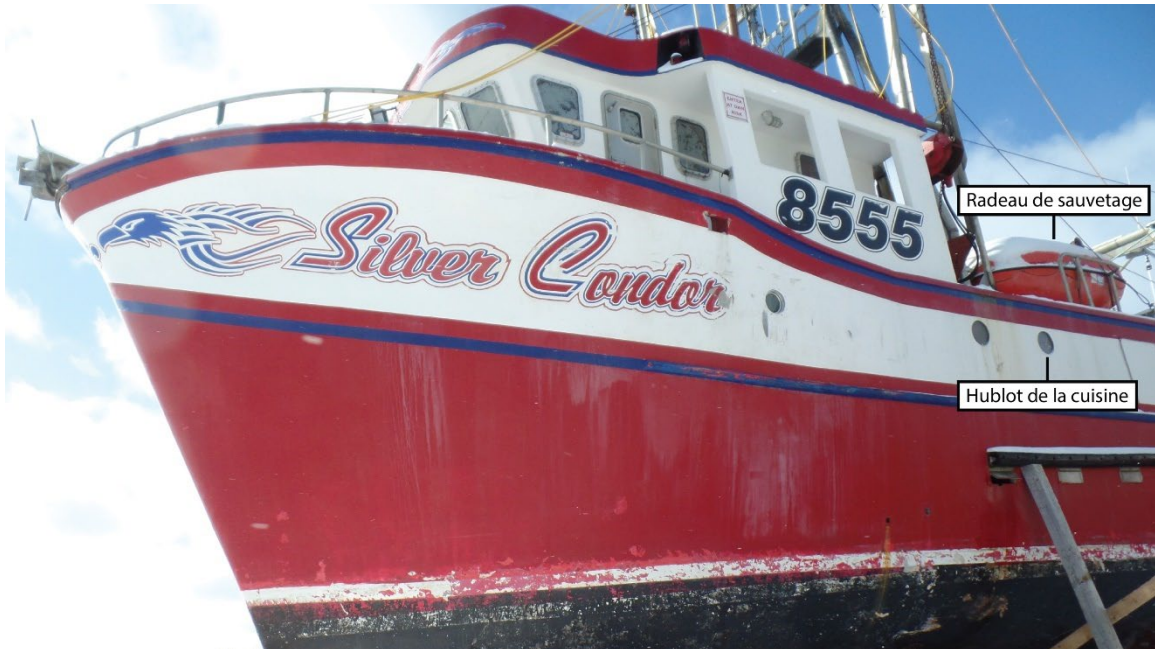
Figure 5. Vue du côté bâbord du Silver Condor, montrant le hublot de la cuisine et le radeau de sauvetage (Source : tierce partie, avec autorisation et avec annotations du BST)
