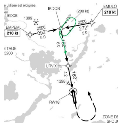
Figure 16. Diagramme montrant la trajectoire de vol à la sortie du circuit d'attente à IKDOB (Source : NAV CANADA, Canada Air Pilot [CAP], CAP 6 : Québec [en vigueur le 5 octobre 2023], avec annotations du BST)
