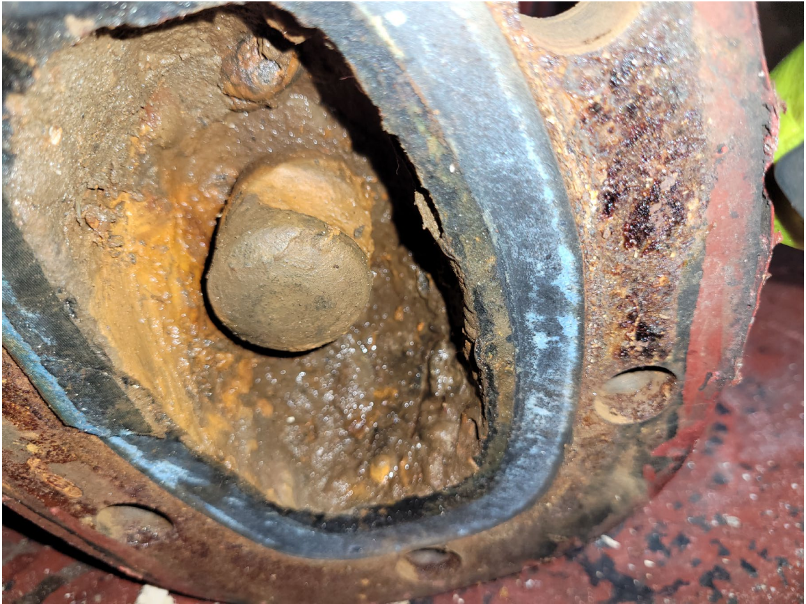
Figure 20. La vanne d'isolement démontée, montrant la tige déconnectée (Source : BST)
