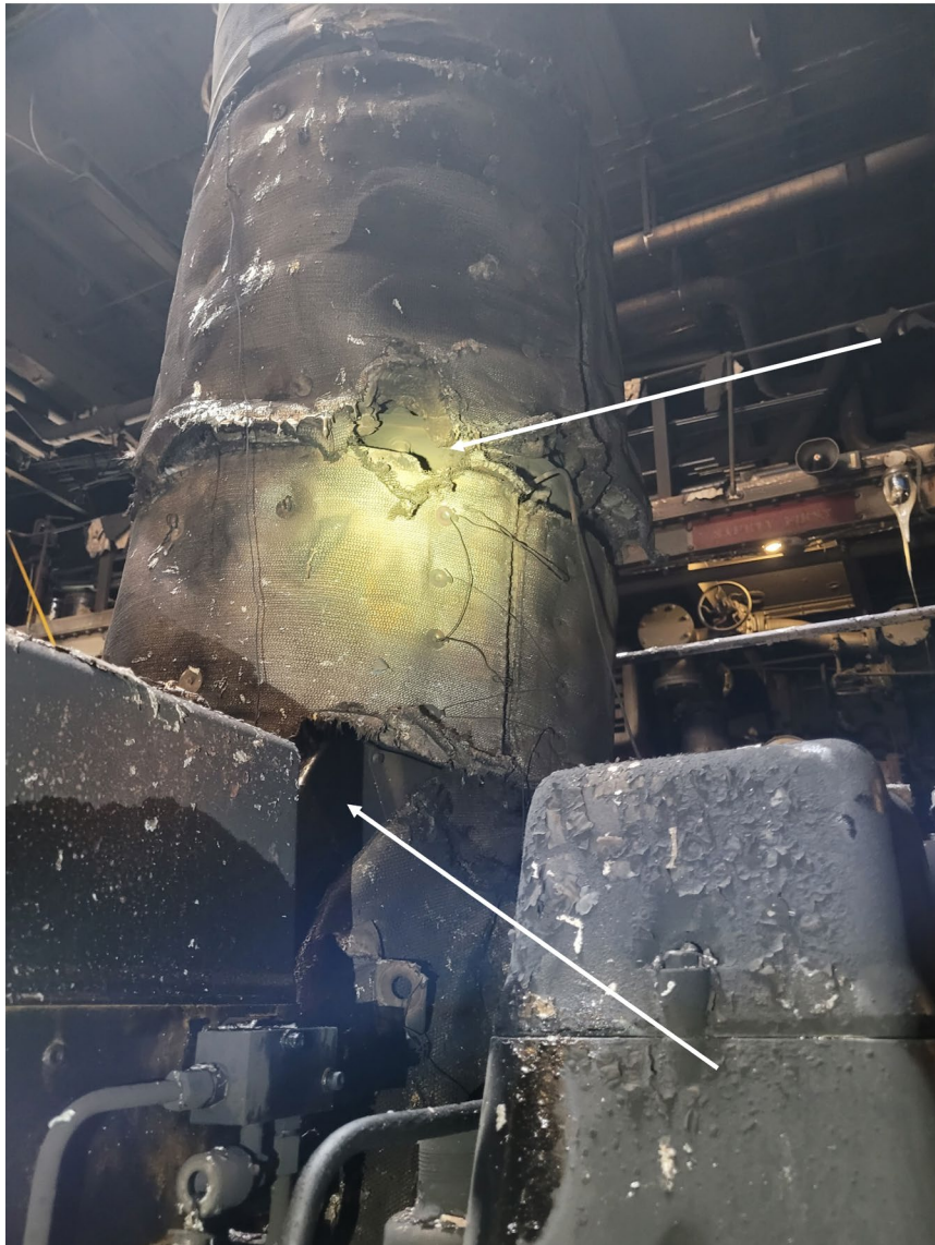
Figure 13. Isolation du turbocompresseur montrant une encoche laissée par l'installation de l'isolant sur la sortie du turbocompresseur (Source : BST)
