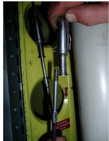
Photo 1. Tendeur rapide et câbles tels que trouvés
